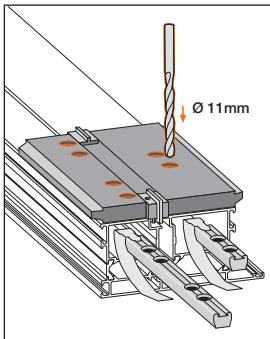
Spän fast borrmall skuggöppningen färs genom distanserna. Borra  $\varnothing$  11 mm. Skjut in förstärkningsplattan i profilen och fixera. Klem fast borelåren, sikre luftspalte ved hjelp av distansstykker. Bor ø11 mm hull, skygge festeplatene inn i profilen under hullene. Borelåren fastklemmes, skyggenoten sikres med avståndsstykker. Der forbres ø 11 mm, befæstigelsesplader skubbes på plads ind i profilet.
